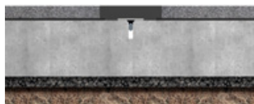
Provedení blokové spáry v oblasti tunelu
